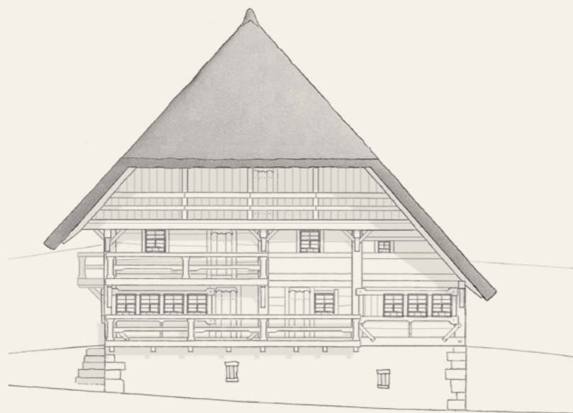
Abb. 71: Der Hof im Oberreichenbächle nach 1934. Der obere Teil wurde durch eine Widerkehr erweitert, der untere Teil zeigt noch den Zustand von nach 1922 mit vorgezogenen Stuben und seitlicher Dachabschleppung.
